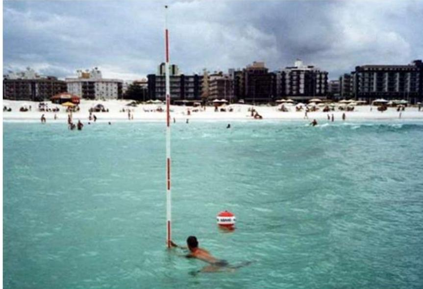
**Figura 22** - Extensão do perfil topográfico para a antepraia. A profundidade medida no local pelo topógrafo localizado na praia.
