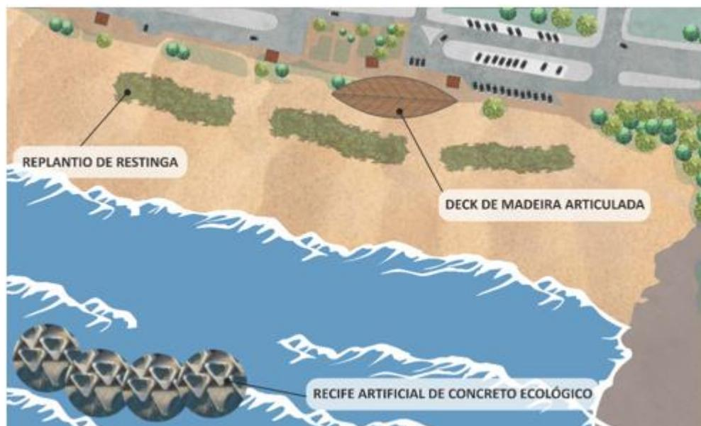
**Figura 94** - Ilha artificial de concreto ecológico proposta para diminuir a energia das ondas no trecho Leste.
