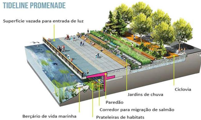
**Figura 56** – Túnel costeiro multipropósito e calçada na Baía de Elliott Seattle - WA EUA.
