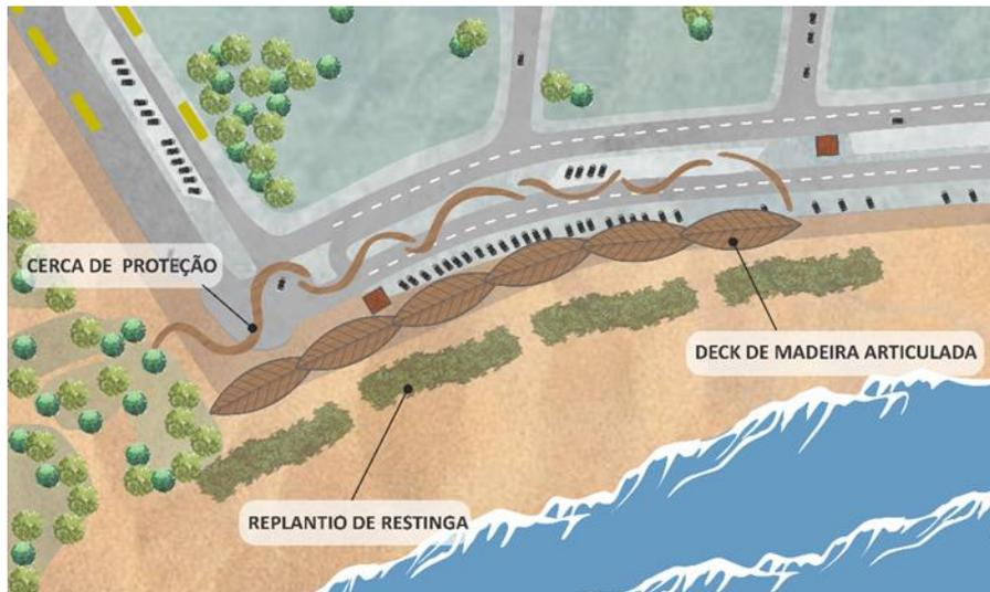
**Figura 92** - Solução híbrida para o trecho oeste deck elevado em madeira certificada e articulada e replantio de restinga como barreira física.
